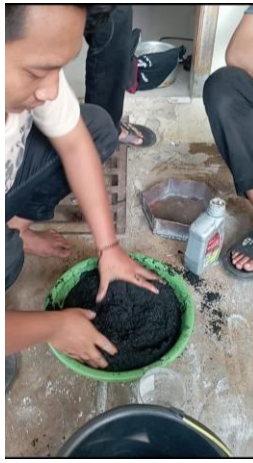
Gambar 1 Proses Pencampuran Bahan dan Pencetakan Briket
